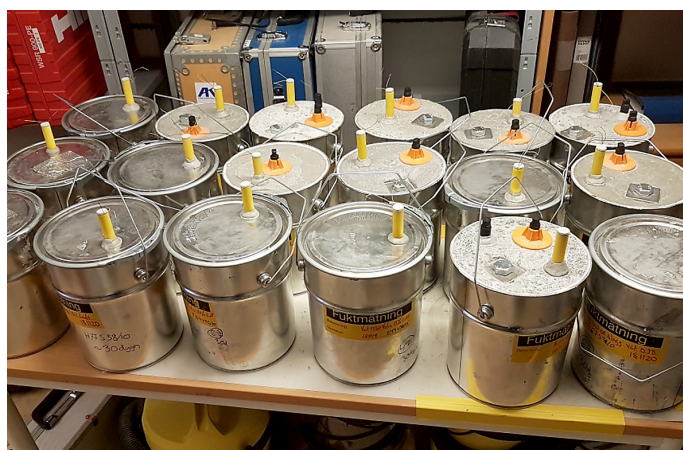
Figur 3: 60 dagar kylt betong med öppna respektive stängda burkar.
