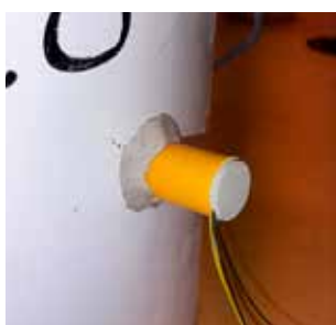
1. Borrhålsmätning med tätning mot plåt.
