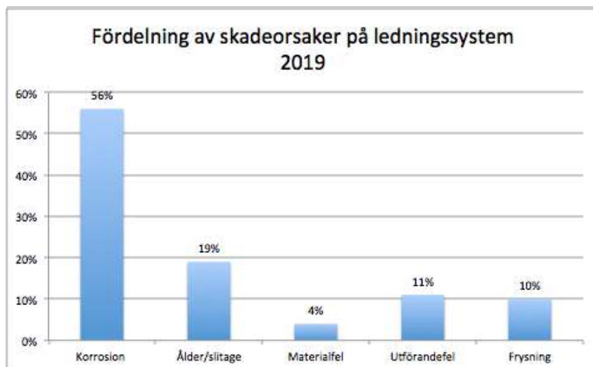
Figur 19, Fördelning av skadeorsaker på ledningssystem 2019. Statistik hämtat från Vattenskadeundersökningen 2019.
