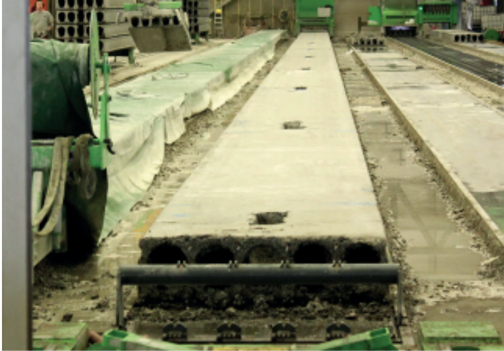
Figur 2.3, Håldäcksplattor i fulla längder före beskärning.
