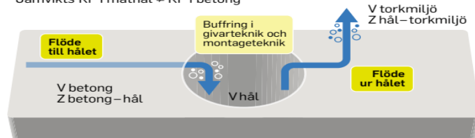
FIGUR 2 Principer för jämvikt i ett mäthål. Ånghaltsskillnaden ( V_{\text{betong}} - V_{\text{hål}} ) måste vara nära noll för att kunna mäta hur blöt betongen är via fuktmätning i hålet.
