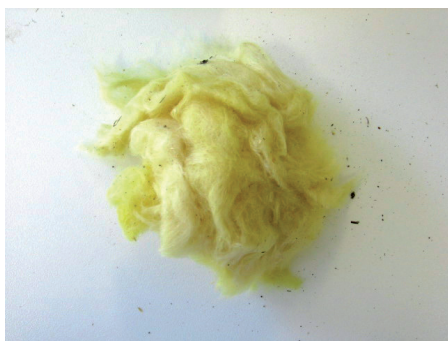
Figur 1: Exempel på skadade materialprov. På den pappersklädda gipsskivan finns det tydliga synliga tecken på skada medan det är mycket svårbedömt okulärt att se påverkan på mineralullsprovet.
