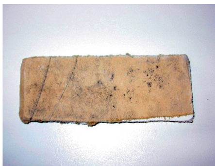
Figur 1: Exempel på skadade materialprov. På den pappersklädda gipsskivan finns det tydliga synliga tecken på skada medan det är mycket svårbedömt okulärt att se påverkan på mineralullsprovet.
