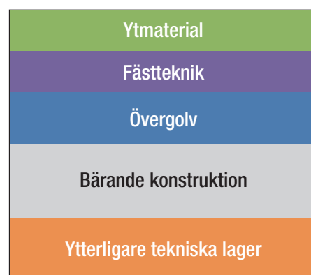
Figur 1: Principiell grov uppbyggnad av golvsystems delar. Alla delar är inte alltid närvarande och varje del innefattar oftast flera tekniska egenskaper.
