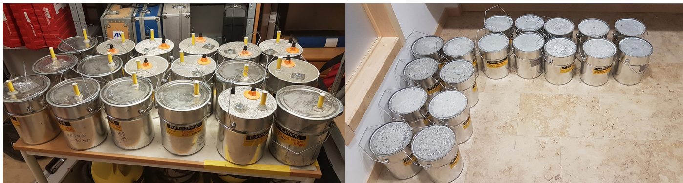
Figur 1: Burkar med betong. Täta burkar för kontroll av kemisk torkning och öppna burkar för kontroll av diffusiv uttorkning. Till vänster burkar för kontinuerlig fuktmätning och t.h burkar för vägning.
